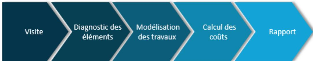
La méthode EPIQR+ propose un découpage technique du bâtiment en cinquante-deux éléments, définis selon un regroupement de composants assurant la même unité fonctionnelle. Le diagnostic de l'état de dégradation est établi au travers de ces cinquante-deux éléments sur la base de quatre codes de dégradation. Suite à ce diagnostic, le programme permet de définir l'importance des travaux de remise en état ainsi que les coûts y relatifs.
